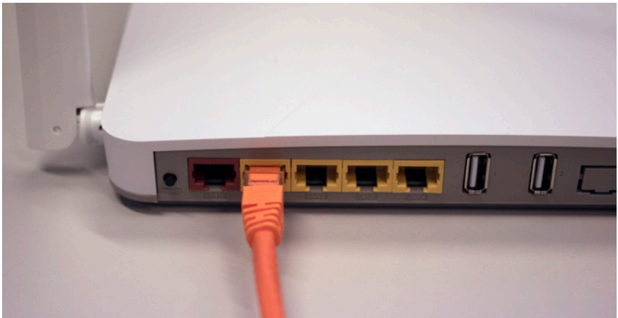
Verkkokaapeli kiinnitettynä päätelaitteen LAN1-porttiin.
